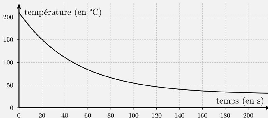
1. L'objet peut être démoulé lorsque sa température devient inférieure à  $50^{\circ}\text{C}$ .
